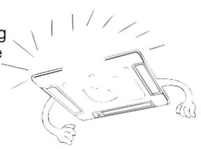
Reinigen Sie den Luftfilter, das Innengerät und das Außengerät und decken Sie das Gerät mit einem Staubschutz ab.
