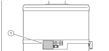
Die Typenbezeichnung und die Seriennummer befinden sich auf dem Typenschild (1).
