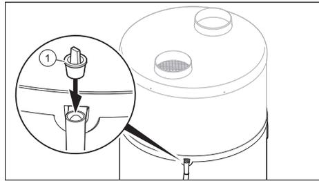
1. Vergewissern Sie sich vor Inbetriebsetzung des Produkts, dass der Stopfen **(1)** am Kondensatablaufanschluss entfernt wurde.
