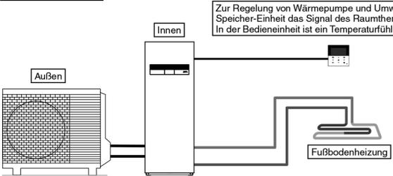
Zur Regelung von Wärmepumpe und Umwälzpumpe empfängt die Hydromodul/Speicher-Einheit das Signal des Raumthermostaten (EIN/AUS) von der Bedieneinheit. In der Bedieneinheit ist ein Temperaturfühler eingebaut.
