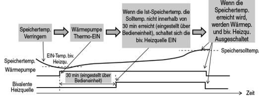
Bivalente Heizquelle Im Erweiterten Parallelbetrieb ist eine getrennte Einstellung für Pufferspeicher und Warmwasserspeicher möglich. Während des Heiz- und Warmwasserbetriebs („HEAT+TANK“) wird der Bivalenzgang bei jeder Umschaltung der Betriebsart auf AUS zurückgesetzt. Für die Auswahl der optimalen Einstellung für das System ist ein gutes Verständnis der der Bivalenzfunktion erforderlich.
