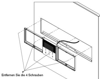
Entfernen Sie die 4 Schrauben
