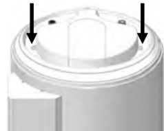
Die 2 Schrauben von der Deckel entfernen
