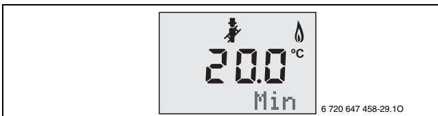
Bild 45 Min (= minimale Nennwärmeleistung) blinkt
